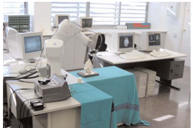
Figura 84 Prototipus de sistema integrat robòtic per osteotomies maxil·lofacials
